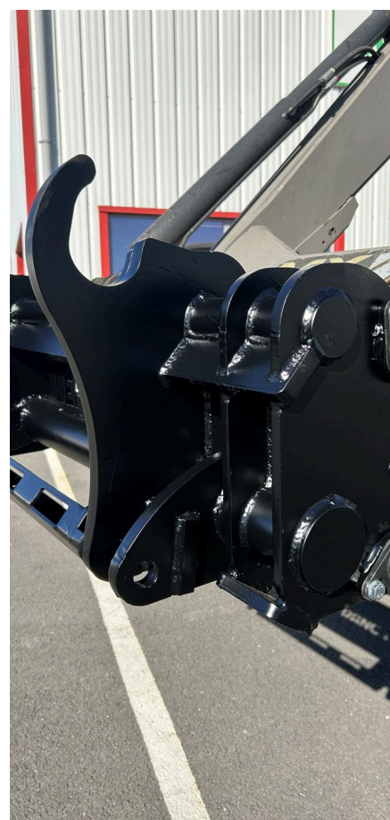
Tablier TX417 — outils Manitou sur fourche Mailleux MX
