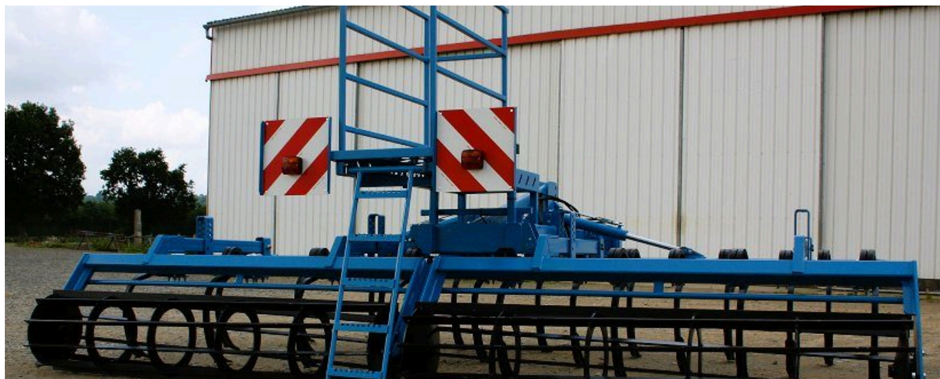
Châssis 3 poutres reposant sur un châssis central porteur monobloc
