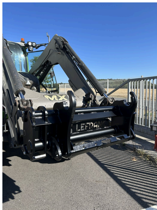
Tablier TX417 — outils Manitou sur fourche Mailleux MX
