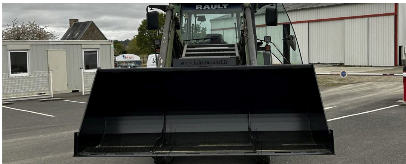
Caisse haute puissance — enveloppe 8 mm et lame d'usure 150 × 20
