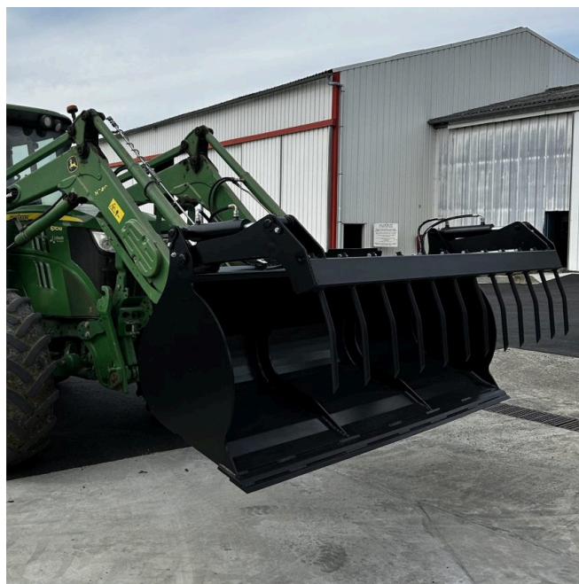
Benne multiservice — godet renforcé et grappin articulé
