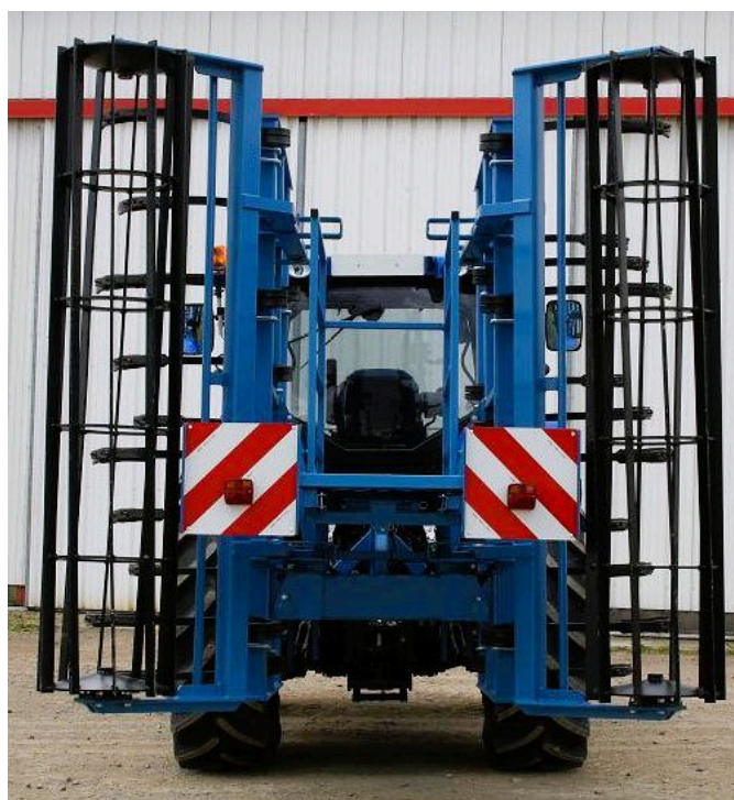
3 points d'articulation renforcés, bagues graissées à vie
