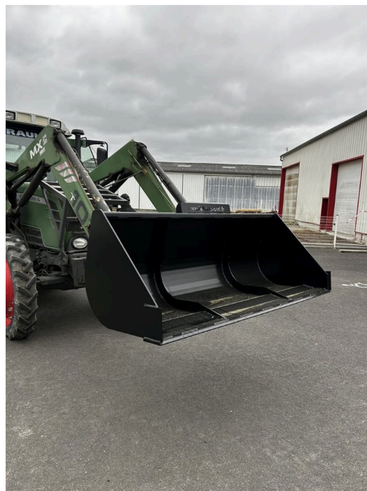
Benne de reprise — lame d'usure en acier anti-abrasion
