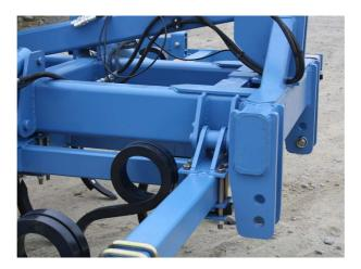
Chaque châssis et articulé par 3 points d'articulation renforcé montée avec des bagues auto lubrifié graissé à vie
