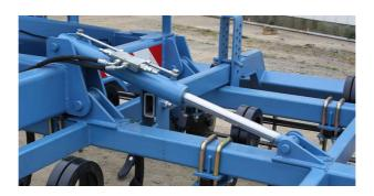
La sécurité de transport et de travail se fait par clapets piloté DE (1 par vérin) ne nécessitent aucune intervention manuelle de l'utilisateur
