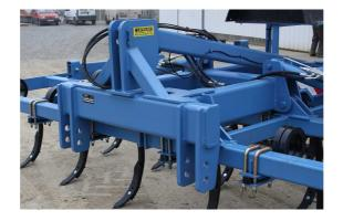
Le porte a faux de l'attelage et réduit au minimum, afin de rapprocher le plus possible l'outil du tracteur.
