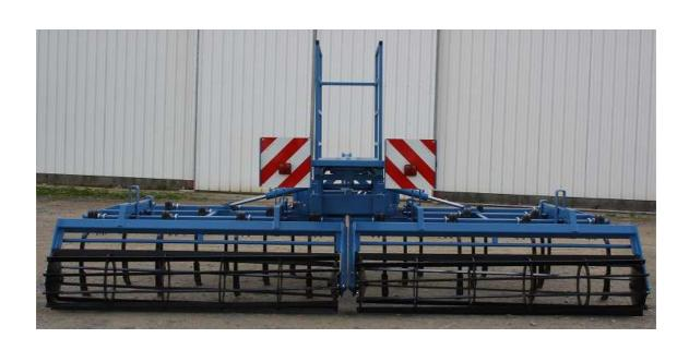
Châssis 3 poutres en tubes 100/100 ep 8 mm reposant sur un châssis central porteur monobloc Dépliage des éléments par 2 vérins hydraulique DE avec chacun 1 clapet piloté type TP
